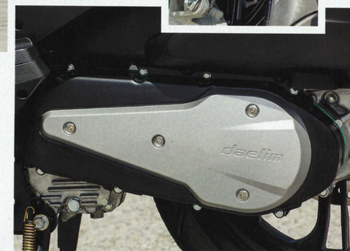
Motor auf Otello-Basis, wassergekühlt, ohne Ölschlaglas. Dafür zwei Federbeine an Bord
