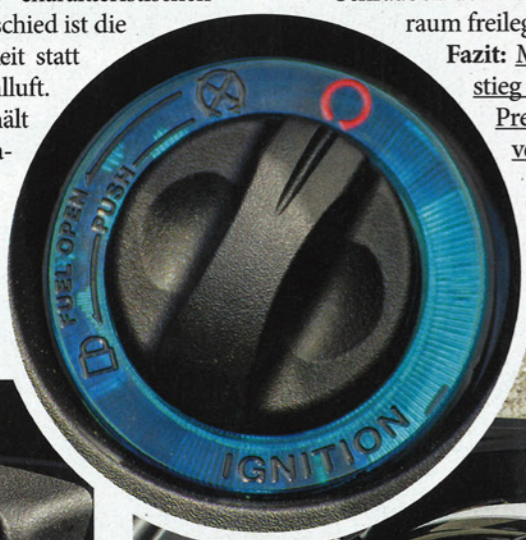
Blauer Ring ums Zündschloß, vom Funkschlüssel drahtlos freigeschaltet. Helmfach per LED beleuchtet
