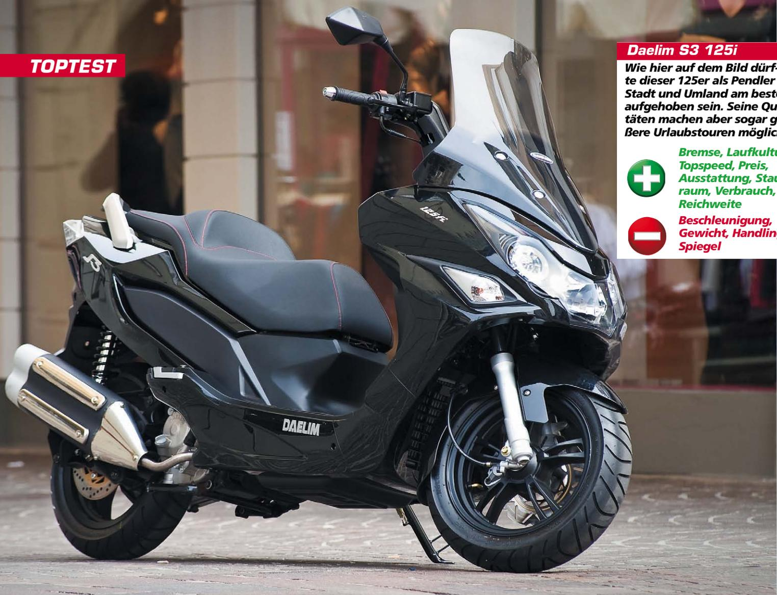
**Fahrwerk:** Die Bremse gehört zu den Glanzstücken am S3. Vorn eine mächtige 240er Wave-Scheibe, die hintere Scheibe baut kaum kleiner. Im Normalbetrieb genügt ein Zug am linken Hebel, denn die Bremsanlage arbeitet kombiniert (CBS).
