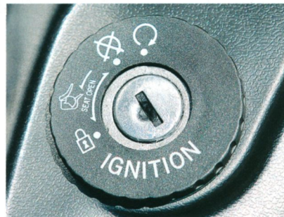
Zündschloß und Lock-Schalter im Helm-fach sichern das Eigentum
