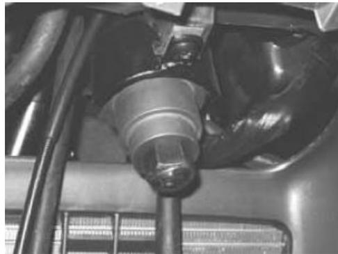
**Bauen Sie Rollenlager auf dem Lenkrohr einsetzen**
