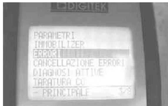
Auf der Seite am Diagnosegerät wird die Liste der Fehler dargestellt, die von der Autodiagnosefunktion ermittelt werden können.
