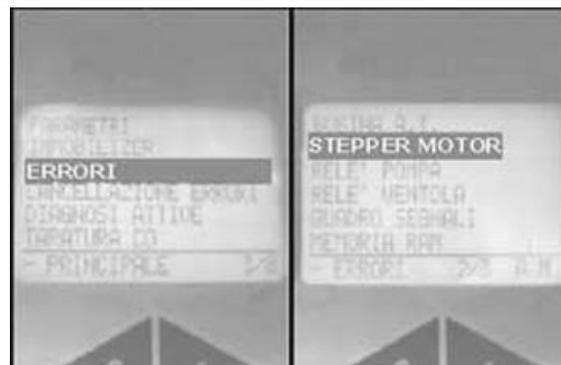
Um eine ungleichmäßige Abnutzung des Reglerkolbens zu vermeiden, wird der Motorbetrieb bei einer Mindestöffnung von 43 ÷ 45 «Schritten» erhalten.
