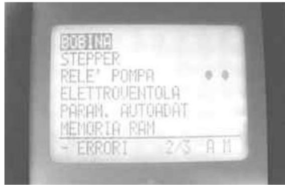
Die Störungen, die von der Autodiagnosefunktion ermittelt werden können, können sich auf folgende Stromkreise oder Bereiche der Zündelektronik beziehen:
