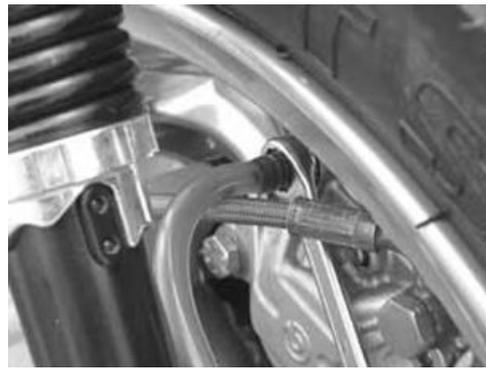
Beim Entlüften der Kombi-Bremsanlage muss als erstes der Bremssattel der Hinterradbremse entlüftet werden.
