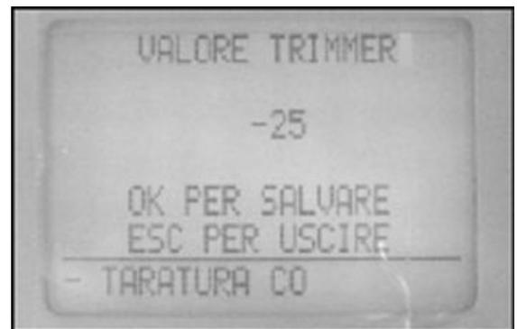
11 - Aus dem Menu am Diagnose-Testgerät die Funktion «CO-EINSTELLUNG» auswählen.
