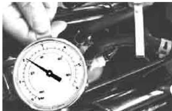
**14** - Das Sperrventil der Benzinpumpe ist defekt. Die Benzinpumpe auswechseln (siehe Revision Pumpenhalter).
