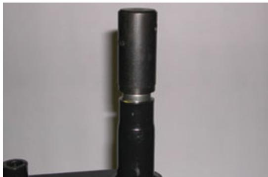
**Auswechseln der Lager am Motorgehäuse**
