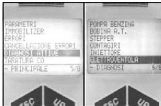
3 - Test erfolgreich abgeschlossen. Das Kühlgebläse funktioniert.
