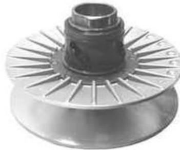
Mit einer Fettpistole mit gekrümmter Düse die Baugruppe geführte Riemenscheibe mit ungefähr 10 g fetten. Das Fett wird solange durch eine der Bohrungen in das Innere der Buchse eingeführt, bis es anfängt auf der gegenüber liegenden Seite auszutreten. Dieser Arbeitsschritt ist notwendig, damit kein Fett hinter die O-Ringe gelangt.
