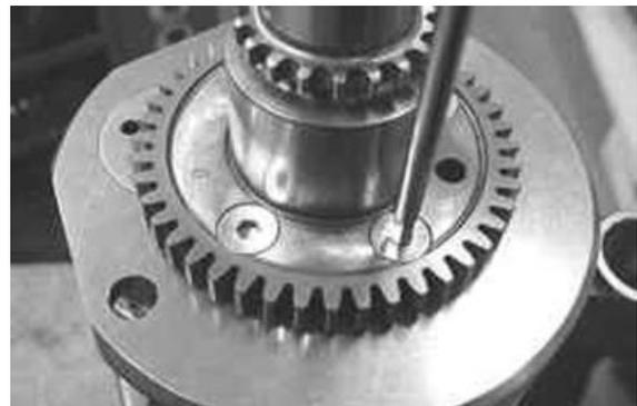
Die Befestigungsbohrungen an beiden Flächen mit Druckluft durchblasen und entfetten, so dass das neue LOCTITE Halt findet.
