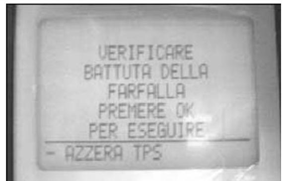
Im Menü die Funktion «PARAMETER» auswählen und prüfen, ob die Anzeige TPS Nullstellen «JA» angezeigt wird.
