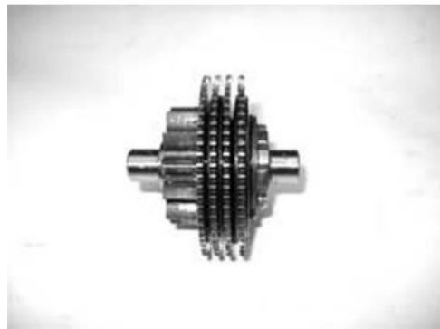
Es kann keine Revision am Drehmomentbegrenzer vorgenommen werden. Sind Beschädigungen an den Zahnscheiben sichtbar, sollte die gesamte Baugruppe ersetzt werden.
