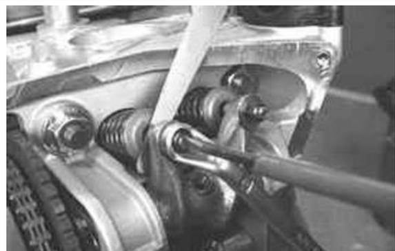
Stellschraube wie in der Abbildung gezeigt mit einem Schraubenzieher verstellen.
