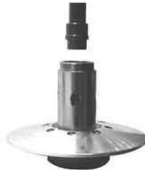
**Spezialwerkzeug****020376Y Handgriff für Adapter****020375Y Adapter 28 x30 mm****020364Y Führung (25 mm)****001467Y002 Korb für Lager mit Außendurchmesser  $\varnothing$  73 mm****Kontrolle feste geführte Riemen-Halbscheibe**
