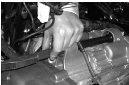
**Einbau der Lager am Motorgehäuse**
